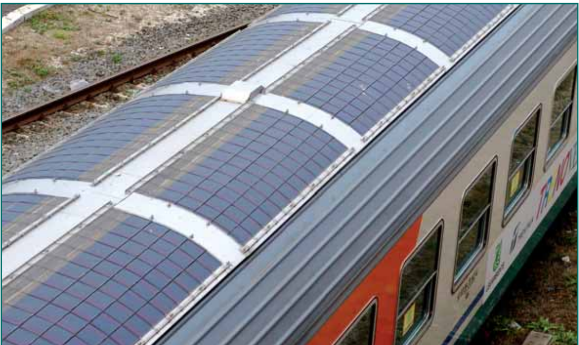
Carrozza PVTRAIN con pannelli fotovoltaici
