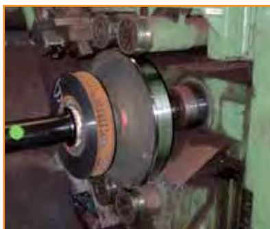
Officina Trenitalia di Vicenza: tornio per la profilatura delle ruote
