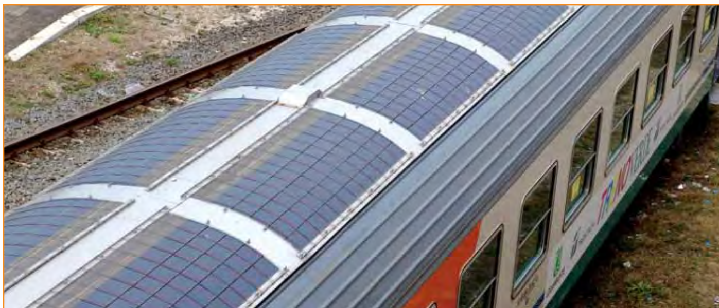
Carrozza PVTRAIN con pannelli fotovoltaici
