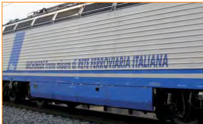
La locomotiva del treno Archimede per le misure meccaniche ed elettriche dell'Infrastruttura Ferroviaria
